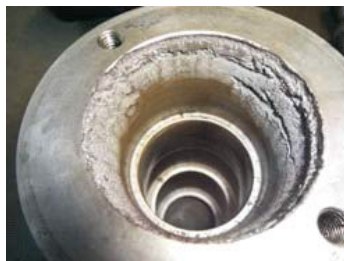
套筒汽蚀严重、完全损坏
