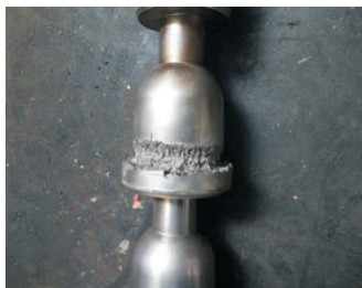
阀芯密封面汽蚀、腐蚀严重
