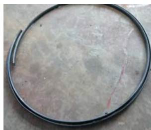
C形环磨损及断裂
