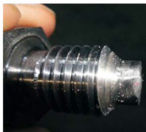
导向销端部磨损 阀杆导槽变形
